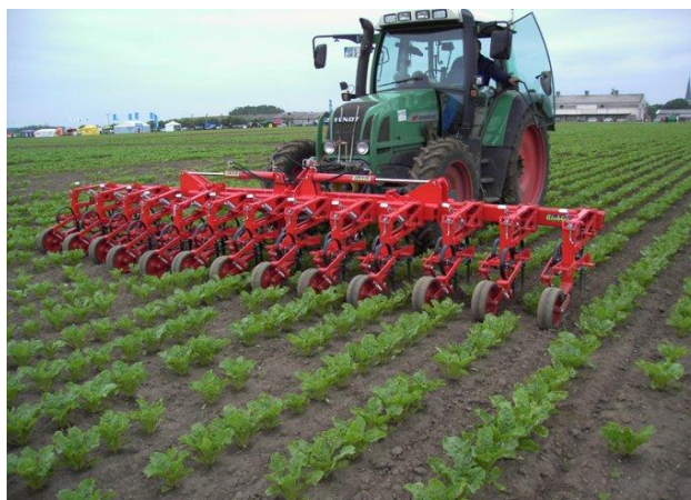
42. ábra Növényápoló talajművelés sorközművelő kultivátorral (Forrás: http://vektor-mezogep.hu )
