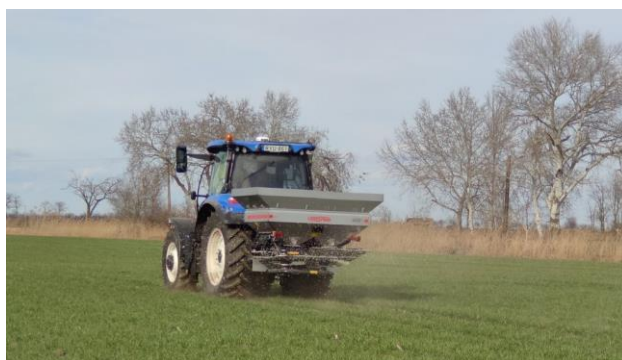
39. ábra Szilárd halmazállapotú szervesetlen trágya kijuttatása
