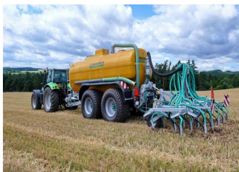
38. ábra Hígtrágya kijuttatása talajba injektálással
