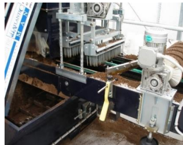
Magvetés szaporítóládába precíziós szemenkéntvető géppel
